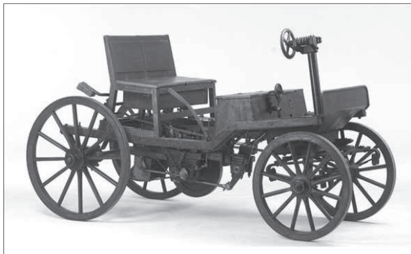
Ryc. 3. Pojazd z silnikiem spalinowym konstrukcji Siegfried'a Samuel'a Marcus'a z 1870 roku (źródło:blog.cars1900.com)
