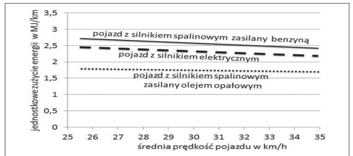
Ryc. 12. Jednostkowe zużycie energii pojazdów w ruchu po mieście w zależności od średniej ich prędkości (Chłopek i in. 2014)
